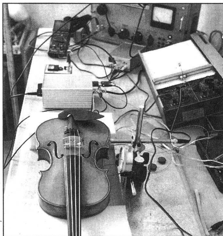
Der letzte Schliff: Mit elektronischem Gerät wird die Resonanzschwingung der Geige getestet.
