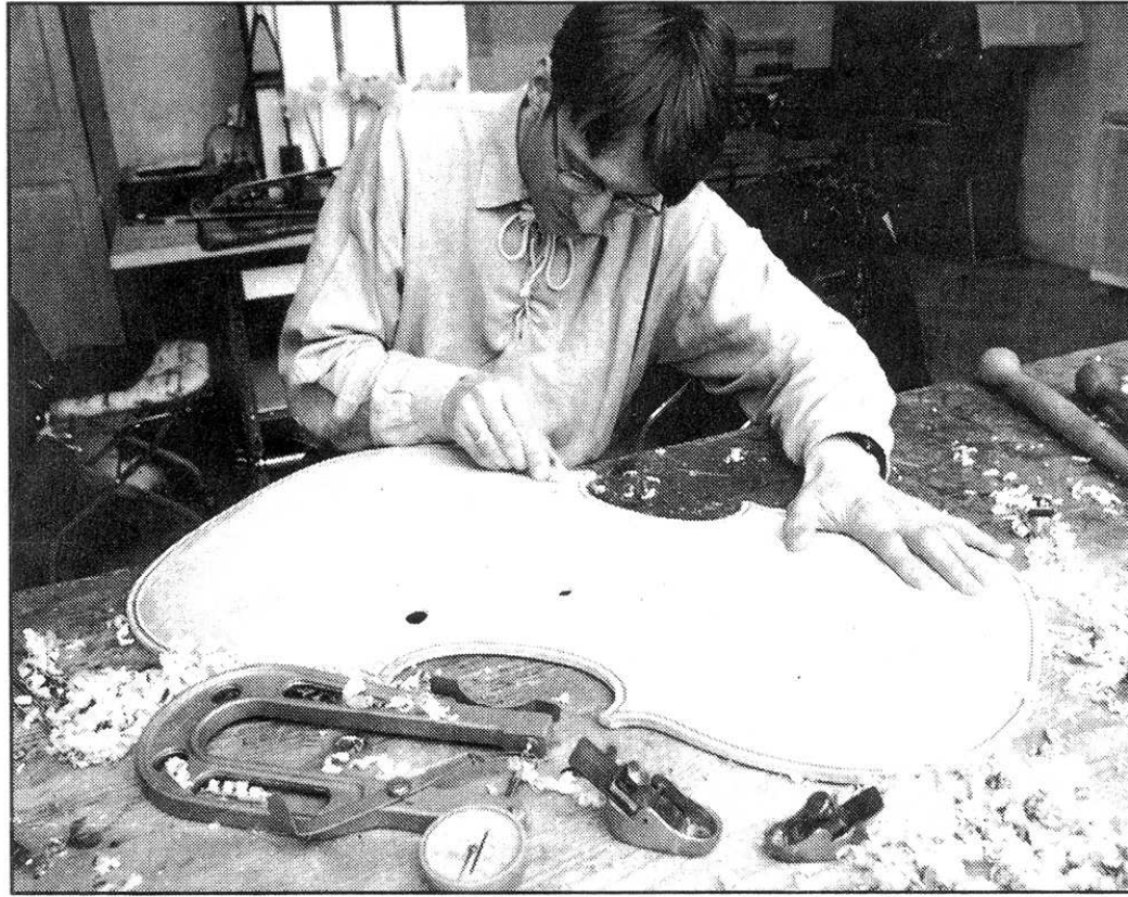
Viel Fingerspitzengefühl braucht Martin Schleske beim Instrumentenbau. Mit einem kleinen Hobel arbeitet er die Wölbung für ein neues Cello heraus.
