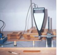
Abb.: Lackschrank mit Einzelsubstanzen und Messung lackierter Probestreifen im Meisteratelier für Geigenbau Martin Schleske
