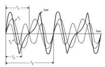
Abb.: Zeitbereich einer Schwingung. Die dicke Linie zeigt die Summe des zweiten und dritten Harmonischen. (F1 bzw. F2) mit der jeweiligen Periodendauer T1 bzw. T2. Die Periodendauer der Summe ist gleich lang wie die Periodendauer der Grundschwingung (T0)!
