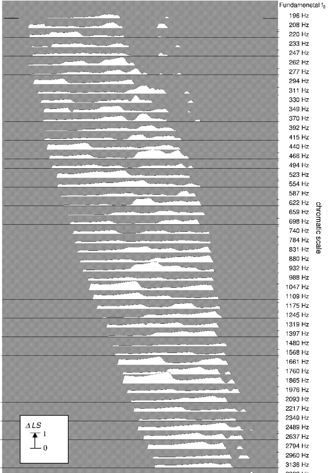
Abb. 2: Darstellung der Vibratoempfindlichkeit (und damit der Modulierbarkeit) einer Geige von Guarneri del Gesu. Vertikale Achse: chromatische Tonleiter (Frequenzen des zugehörigen Grundtones). Horizontale Achse: „Frequenzachse des Innenohres“ (ERB-Skala)
