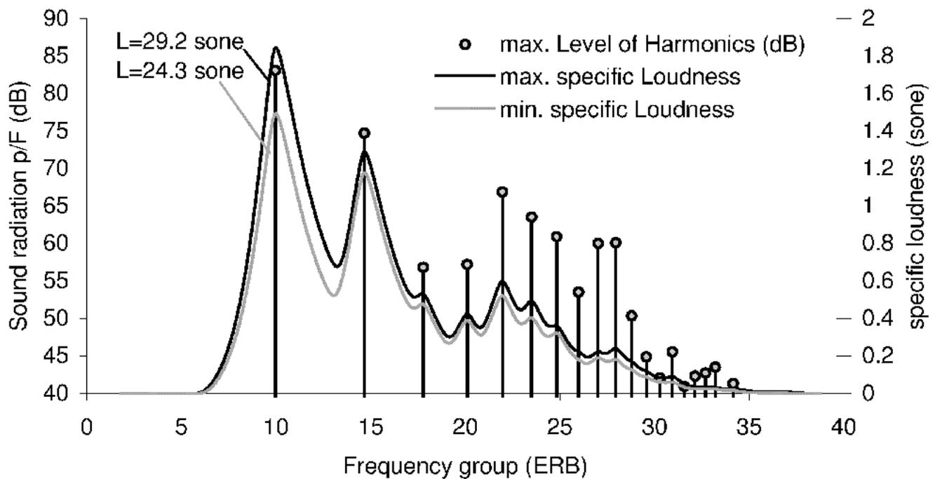
Abb. 1: Erregungsmuster des Innenohres beim Hören eines gestrichenen Geigentones. Graue Kurve: spezifische Lautheit aufgrund der minimalen harmonischen Pegel innerhalb des Vibratoshifts. Schwarze Kurve: spezifische Lautheit aufgrund der maximalen harmonischen Pegel.
