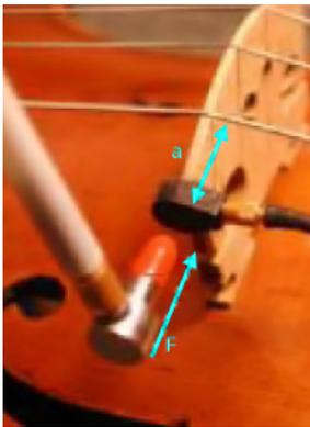
Messung einer Übertragungsfunktion
