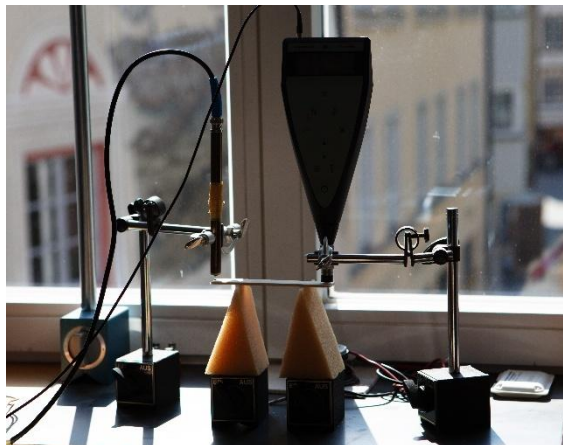
Abb. 4: Messaufbau zur Bestimmung der akustischen Qualität von Geigenlack. Die Probestreifen werden elektromagnetisch in Schwingung versetzt. Die Schwingungsantwort wird über ein Messmikrophon aufgezeichnet und durch Fouriertransformation ausgewertet.
