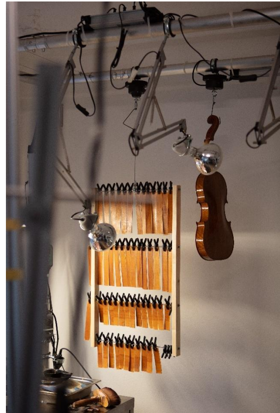
Abb. 8: Trocknung und Bestrahlung der unterschiedlich behandelten und lackierten Probeholzstreifen.
