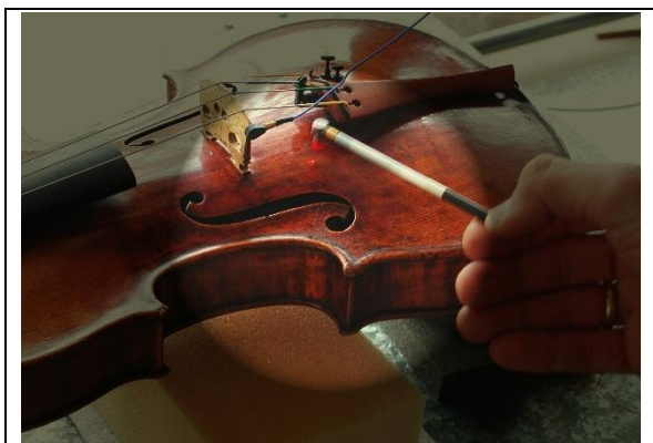
Abb. 4: Modalanalyse einer Violine von Antonio Stradivari aus dem Jahr 1731.
