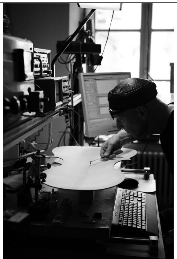
Abb. 1: Modalanalyse einer Cellodecke im Werdegang. Der mit Linearkugellagern und Wegaufnehmern ausgestattete Koordinatenmesstisch dient der exakten Messpunktebestimmung.
