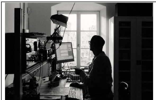
Abb. 3: Ansicht auf den Messplatz zur Modalanalyse von Streichinstrumenten.
