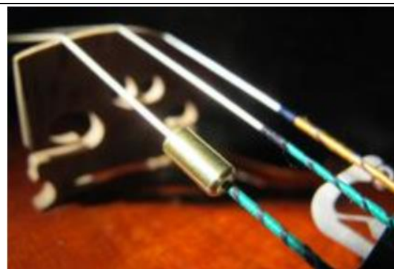
Abb. 3: Im Labor des Meisteratelier für Geigenbau Martin Schleske entwickelter Anti-Resonator zur Eliminierung des Wolfstones von Geigen.
