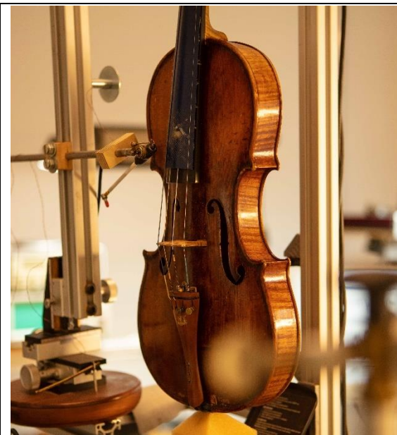
Abb. 3: Geige von Joseph Guarneri. Resonanzanalyse im Akustiklabor unseres Geigenbauateliers.
