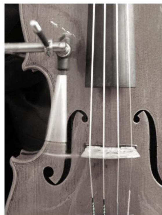
Abb. 5: Anregungsmimik: Stativ mit kugelgelagertem Impulshammer-Pedel.
